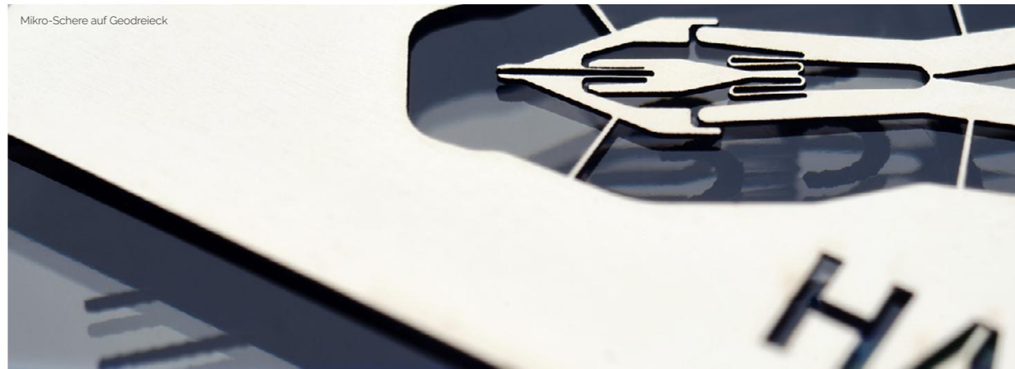
Miniaturisierte Komponenten sind immer bedeutender für innovative Branchen. Mit Hilfe des UKP-Lasermikroschneidens lassen sich feinste Formen mit Toleranzen im  $\mu\text{m}$ -Bereich, gratfrei und hundertprozentig reproduzierbar in Blechstärken von 10  $\mu\text{m}$  bis 500  $\mu\text{m}$  herstellen. Durch die ultrakurzen, extrem energiereichen Pulse, wird das Material direkt sublimiert. Dadurch entsteht an den Schnittkanten keine Wärmeeinflusszone (HAZ).
