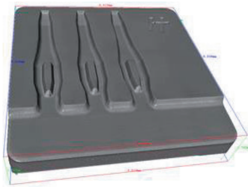
Hartmetall-Prägestempel für Einpresszonen aus dem Werkstoff Ceratizit CF-H40S+, Konturentiefe 400 Mikrometer
