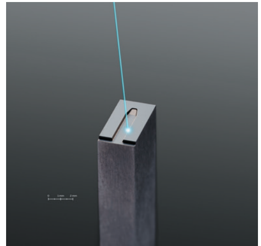
Ultrakurzpuls-Laserbearbeiteter Prägestempel aus CF-H40S+
