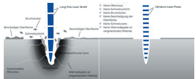
Vergleich: „Klassischer Laser“ vs „Ultrakurzpuls-Laser“
