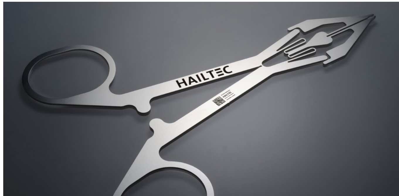
Der UKP-Laser markiert UDI (Unique Device Identification) gemäß EU-Medizinprodukte-Verordnung (MDR)
