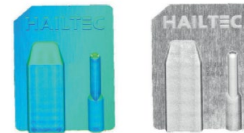
3D-Messung eines Prägestempels mit KI-gestützter Messtechnik: Die CAD-Abweichung lässt sich mit Falschfarben oder Soll-Ist-Vergleich darstellen.
