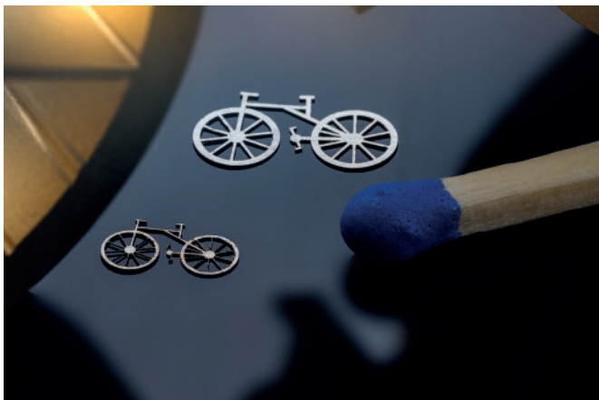
Laserfeingeschnittene Komponente aus 1.4310 t=0,1 mm
