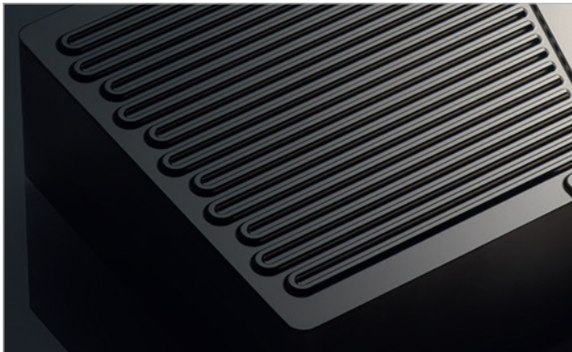
Form- und Prägewerkzeug aus gehärtetem Stahl
